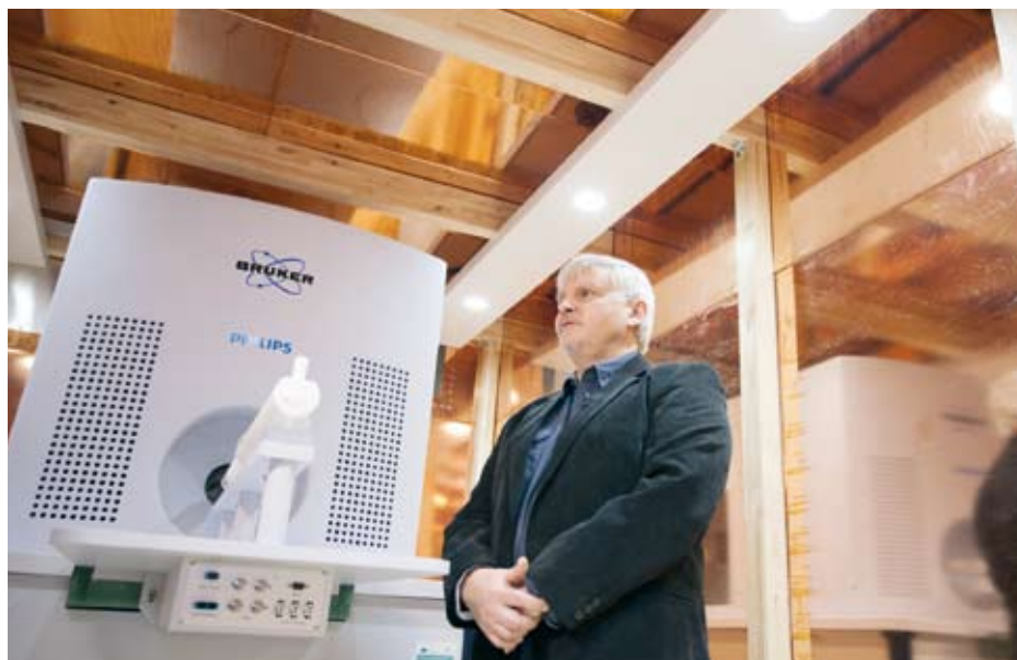
Luděk Šefc vysvětluje, že přístroj MPI, který je umístěn ve Faradayově kleci, je 1000krát rychlejší než pozitronová emisní tomografie a 100krát citlivější než magnetická rezonance.
